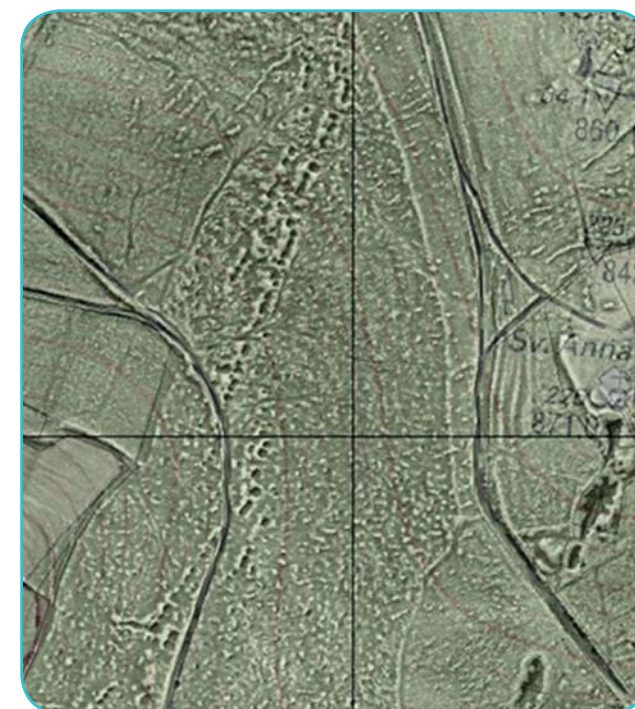
120 Suchá Rudná (okres Bruntál). Dílčí revír Vysoká-jih s pozdně středověkými průzkumnými důlními tahy v digitálním modelu reliéfu z dat laserového leteckého skenování. Zdroj dat: CzechGlobe. Autor vizualizace: Ondřej Malina.
