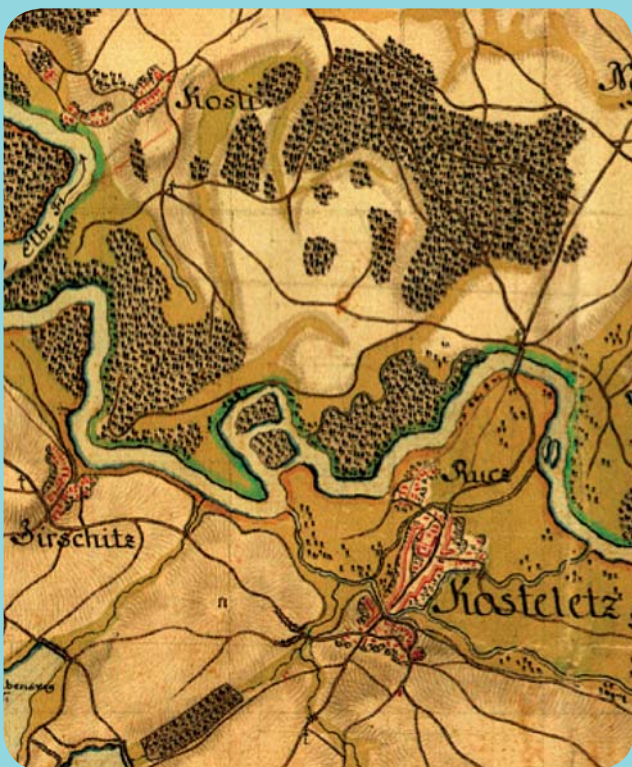
29 Mapový list prvního vojenského (josefského) mapování (tzv. císařský povinný otisk). Je na něm zachyceno koryto Labe poblíž Kostelce n. L. ve své původní podobě. Dobře je vidět způsob zakreslování výškopisu stínováním a tenkými čarami (cca 1770–1780).
