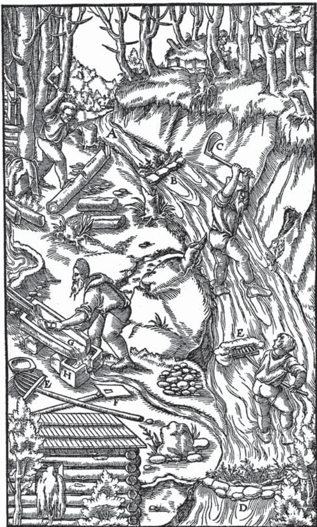
Der Bach A. Der Graben B. Die Breithaue C. Die Rasen D. Die Stifengabel E. Die eiserne Schaufel F. Der Trog G. Ein anderer daruntergestellter Trog H. Eine kleine hölzerne Schaufel I.
