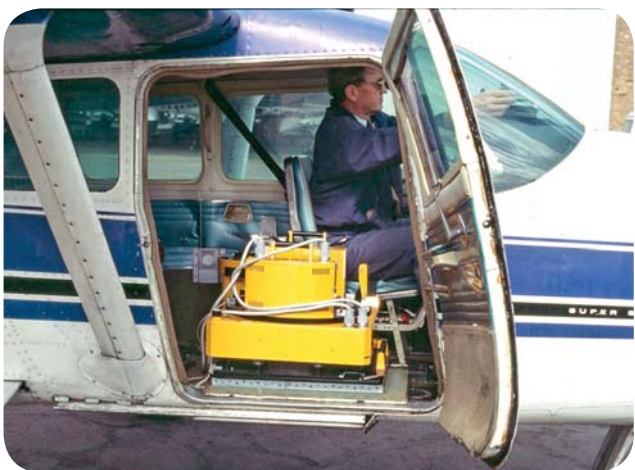
22 Speciální letecká fotografická kamera pro pořizování měřických (kolmých) snímků zabudovaná do podlahy letadla Cessna Super Skymaster. Foto: Martin Gojda.
